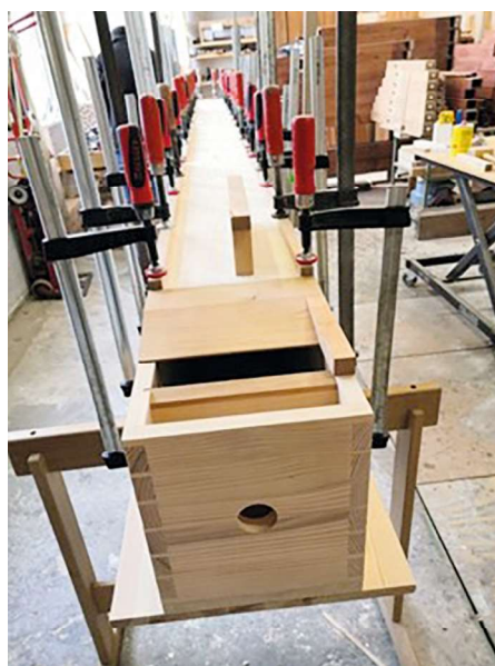
Bau der längsten Orgelpfeife unserer Orgel mit etwa fünf Metern Länge
