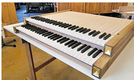
Die Manualklavaturen sind fertig!
